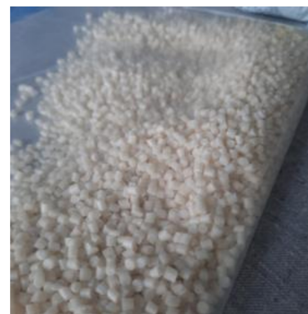
Bild 4 und 5: Kunststoff-Pellets zur Filamentherstellung und Filament für den 3D-Druck am USB
