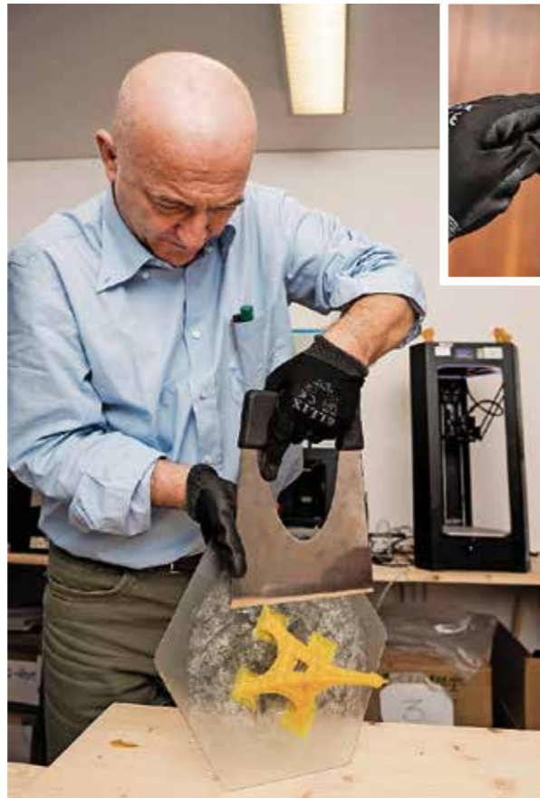
Mauro Rossolato entfernt das Objekt von der Druckplatte (links) und vollendet die Arbeit, indem er überschüssige Fäden mit der Bürste beseitigt.
