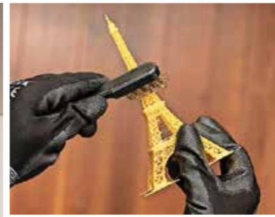
Mauro Rossolato entfernt das Objekt von der Druckplatte (links) und vollendet die Arbeit, indem er überschüssige Fäden mit der Bürste beseitigt.
