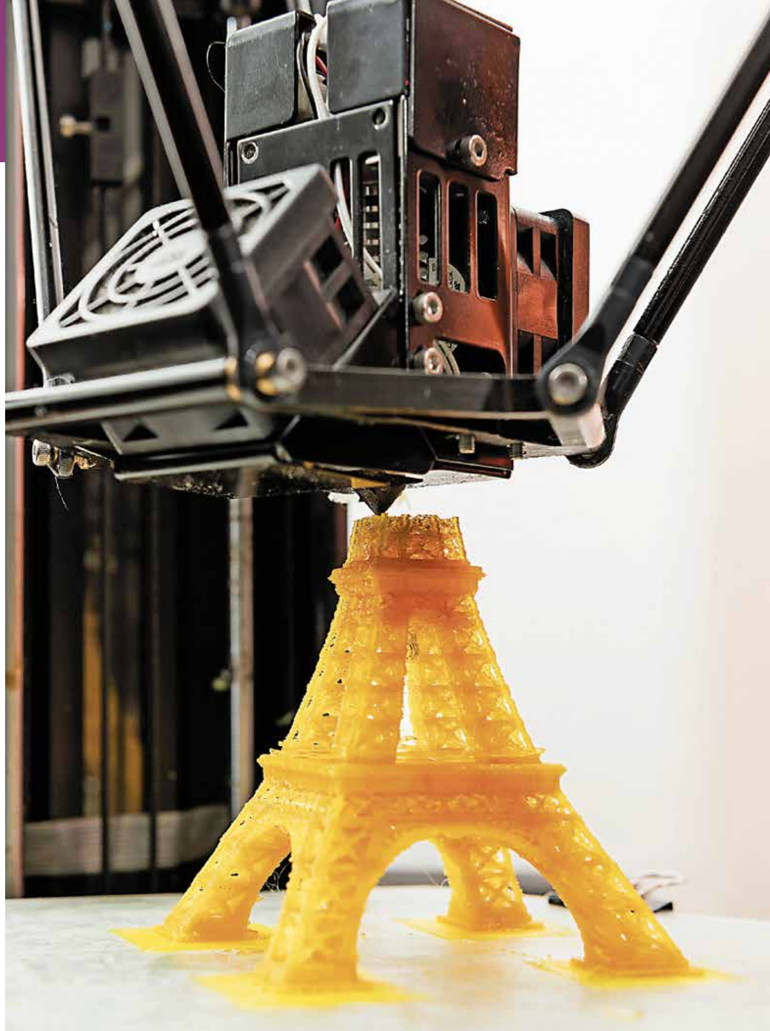
Der «Overlord Pro» des «FabLab» in Grono GR bei der Arbeit: der Eiffelturm kurz vor der Vollendung.
